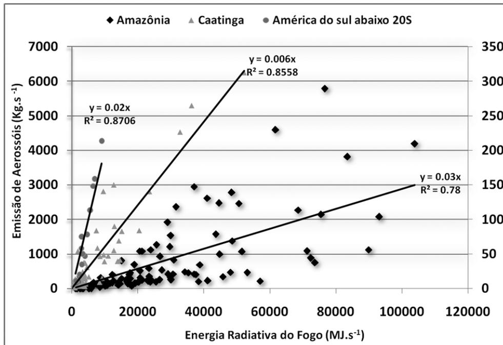
**Figura 1** – Regressão entre a ERF e a emissão de aerossóis para três regiões da América do Sul. O eixo x representa a energia radiativa do fogo, em  $\text{MJ}\cdot\text{s}^{-1}$ , e o eixo y a emissão de aerossóis, em  $\text{kg}\cdot\text{s}^{-1}$ . Para os dados referentes à Amazônia, os valores do eixo x e estão posicionados à esquerda, para os dados da Caatinga e América do Sul abaixo de  $20^{\circ}\text{S}$  estão localizados à direita do gráfico.
